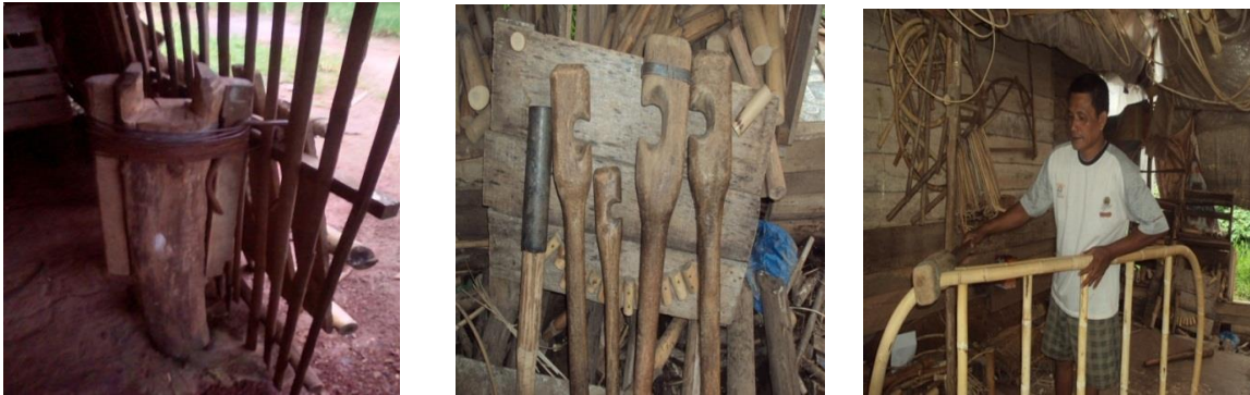
Gambar 1. Alat Tanggam dan Catok untuk membentuk lengkungan rotan
